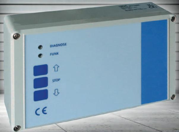
Universale Rolltorsteuerung für Tore mit 230V Einphasen-Wechselstrommotoren mit eigenen Endschaltern. Das Gerät besitzt spritzwassergeschützte Bedientasten für AUF - STOPP - ZU mit zusätzlichen Diagnoseanzeigen. Für die schnelle Inbetriebnahme ist das Gerät bereits mit einem Netzkabel (Schuko-Stecker) vorgerüstet.
