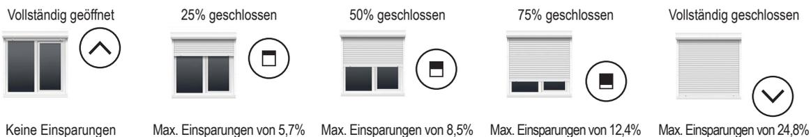
Die Enjoy Rolladenmotoren erzeugen diese 3 Zwischenstufen automatisch, sodass der Benutzer seine Rollläden über 6-Tastensender zu jeder Tageszeit an der richtigen Position positionieren kann.
