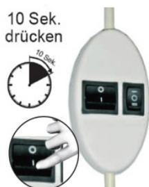
Zur Löschung der Endlagen die Programmiertaste des Programmiersets „ELM“ für 10 Sekunden betätigen.
