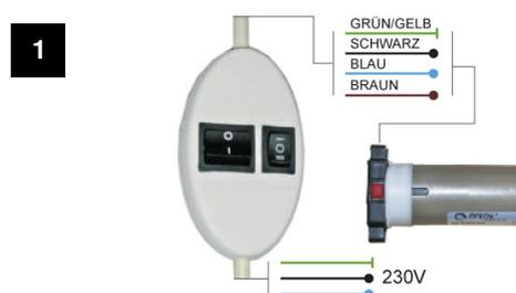
Einstellhilfe anschließen. Übereinstimmung der Fahrrichtungen überprüfen, ggf. braune und schwarze Ader tauschen.
