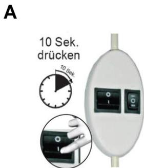
Zur Löschung der Endlagen die Programmierstaste des Programmiersets „ELM“ für 10 Sekunden betätigen. Danach für 3 Sekunden in Stellung „0“ verharren lassen.
