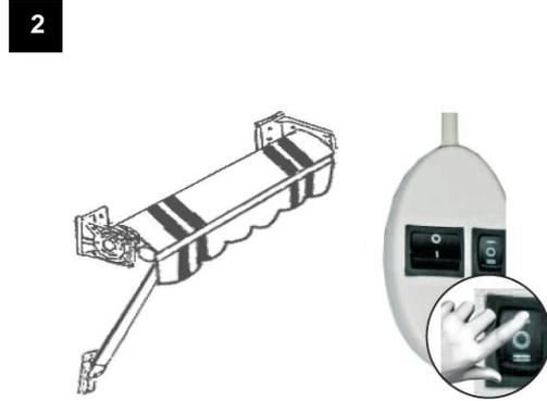
Auf-Taste drücken. Motor startet in Einfahr-Richtung. Solange festhalten, bis der Motor eigenständig abschaltet.
