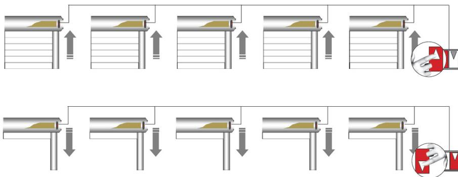
Durch die Parallelschaltung mehrerer Antriebe mit einem Gruppentaster können alle Antriebe gleichzeitig bedient werden.
