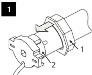
Adapterring (1) bis Stellung (2) der Endschaltung durchschieben, bis dieser richtig auf dem Nocken des Stellrings sitzt.
