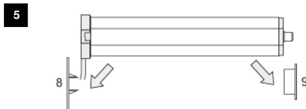
Die Antriebswelle mit Antrieb in die montierten Wandlager (8) und (9) einsetzen. Achten Sie darauf, dass die Einstellschrauben am Antriebskopf gut zugänglich sind.
