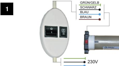
Einstellhilfe anschließen. Übereinstimmung der Fahrrichtungen überprüfen, ggf. braune und schwarze Ader tauschen.
