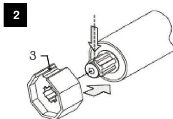
Wellen-Kupplung (3) auf Getriebebolzen schieben, bis Kupplung einrastet.
