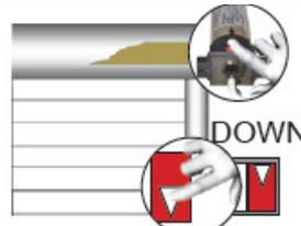
Zusätzlich zur Ab-Taste die Motortaste betätigen und bei Erreichen der gewünschten Endlage Tasten loslassen.
