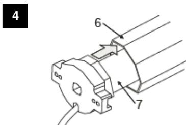
Den Einsteckantrieb (7) komplett in die Welle (6) bis zur Wulst des Stellrings einschieben. NIEMALS EINSCHLAGEN!
