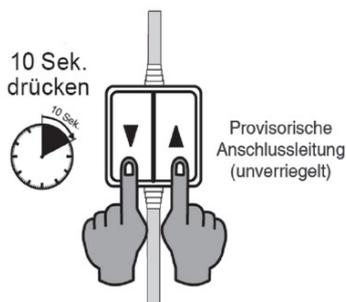
Zur Löschung der Endlagen beide Tasten der provisorischen Anschlussleitung (unverriegelter Doppeltaster) für 10 Sekunden betätigen.
