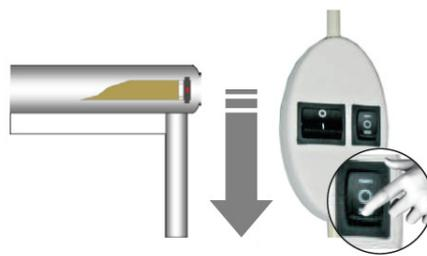
Ab-Taste drücken. Motor startet in Ab-Richtung. Solange festhalten bis die Endlage erreicht ist.
