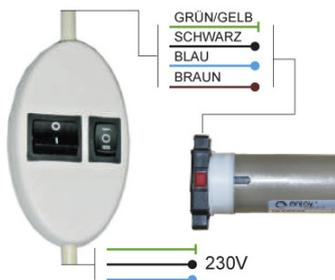
Einstellhilfe anschließen. Übereinstimmung der Fahrrichtungen überprüfen, ggf. braune und schwarze Ader tauschen.
