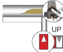
Zusätzlich zur Auf-Taste die Motortaste betätigen und bei Erreichen der gewünschten Endlage Tasten loslassen.
