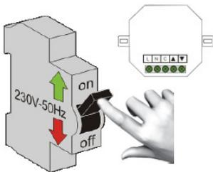
Nach korrektem Anschluss des Empfängers Netzversorgung einschalten.
