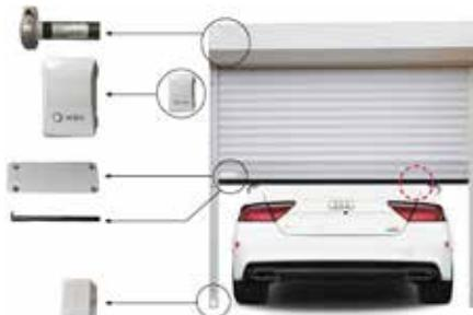
RECMAD03 es compatible con el sistema de parada de seguridad para enrollables más conocido como "**safety edge**". Este sistema se compone de 3 elementos:
