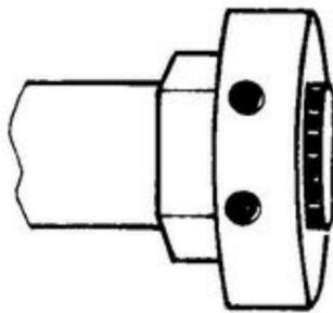
Motor in 12 versch. Positionen drehbar. Bügel sichert den Motor zusätzlich.
